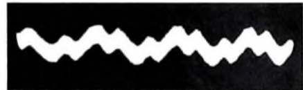
Bild 34. Charakteristisches Störspannungsozillogramm beim Messen des Fremdspannungsabstands
