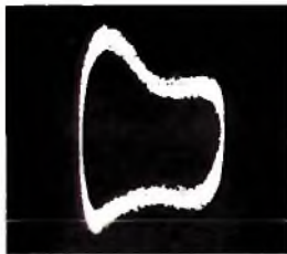
Bild 41 Durch Verzerrungen — vor allem infolge der fehlenden Vormagnetisierung — entsteht meist kein genau runder Kreis
