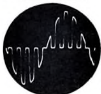
Bild 4. „38-kHz-Schalter“ und resultierendes Signal
