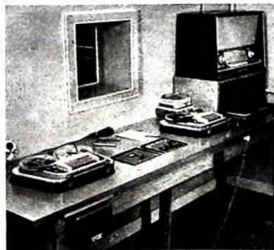
Bild 1. Tonstudio mit getrenntem Aufnahmezimmer für Mono- und Stereo-Aufnahmen, die künstlich verhallt werden können. Das linke Tonbandgerät dient zur Wiedergabe der Playbacks.
