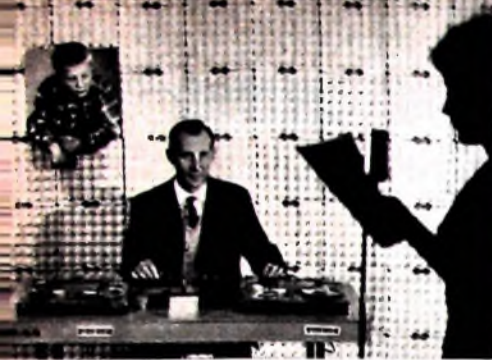
Bild 3. Regietisch für zwei Tonbandgeräte, die wahlweise für Aufnahme oder Playback-Wiedergabe verwendet werden können. Gemischt wird mit zwei Regiemixern, der eine für den linken Kanal und der andere für den rechten Kanal
