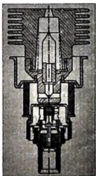
Bild 1 Medioner Längsschnitt durch die Metall-Keramik-Röhre 2C39BA (aus H. H. Meinke u. F. W. Gundlach, Taschenbuch der Hochfrequenztechnik, 2. Auflage, 1962)
