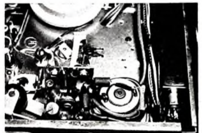
Bild 3. Chassis-Teilansicht des Tonbandgerätes „TK 6“ von Grundig; vorn rechts die Stirnseite des HF-geregelten Antriebsmotors, daneben die Bauelemente des HF-Generators und der Schaltschleife
