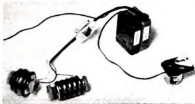
Bild 5. Zweikanal-Empfangsanlage mit Stromquellen und Zweikanal-Rudermaschine
