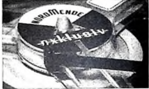
Bild 46: Eine auf den Steg einer Bandschleife gestellte handelsübliche Bandklammer ersetzt notfalls eine Meßschleife, wenn das Bremsmoment des Abwickelers zu messen ist
