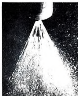
Bild 5. Einspritzvorgang 4 ms nach Beginn des elektrischen Impulses für das Magnetventil
