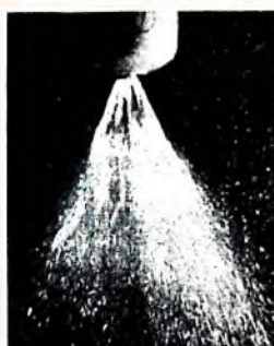
Bild 4. Einspritzvorgang 31 ms nach Beginn des elektrischen Impulses für das Magnetventil
