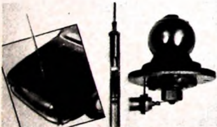
Bild 1. KW-Mobilantenne „Bandspanner“ von Webster; links: an der hinteren Stoßstange eines Personenzugwagens montiert, Mitte: abstimmbare Verlängerungsspule, rechts: Montagefuß für Karosseriebefestigung
