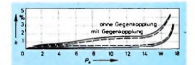
Bild 6. Klirrfaktor k mit und ohne Gegenkopplung in Abhängigkeit von der Ausgangsleistung P_a bei f = 1 kHz und Mittelstellung des Balancereglers (Signaleingang a 1; Reglerstellungen: — = L_{max} , H_{min} , T_{min} ; - - - = L_{max} , H_{max} , T_{max} )
