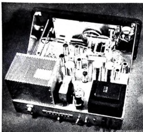
Bild 6 Gesamtansicht bei abgenommener Haube; links ist die TVI-sichere, völlig abgeschirmte Endstufe sichtbar, daneben der Netzteil mit dem Netztransformator
