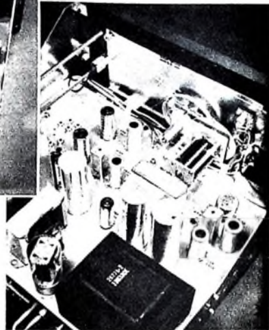
Bild 7 Chassisansicht mit VFO-Abstimmung, HF-Teil und automatischer Sprachsteuerung
