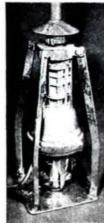
Bild 3. Der Antennenrotor mit Oberlager
