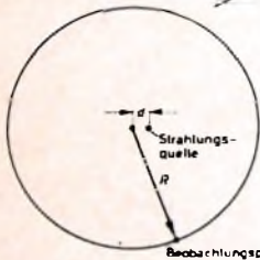
Bild 3. Im Beobachtungskreis exzentrisch liegende Strahlungsquelle
