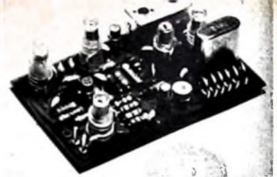
Bild 2. Der 2-m-Konverter auf einer gedruckten Platine
