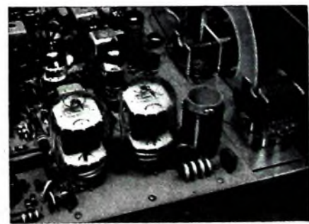
Bild 5. Blick auf den Aufbau der Endstufe mit Pi-Filter und Anodendrehkondensator
