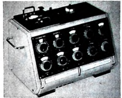
Bild 5. Universal-Adapter zum Röhrenmeßgerät „55a“ (Grundig)
