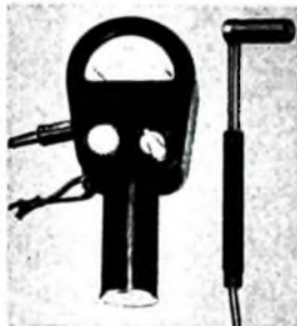
Bild 17. Thermo-Anemometer für Luftgeschwindigkeits- und Temperaturmessungen (A. Thies)
