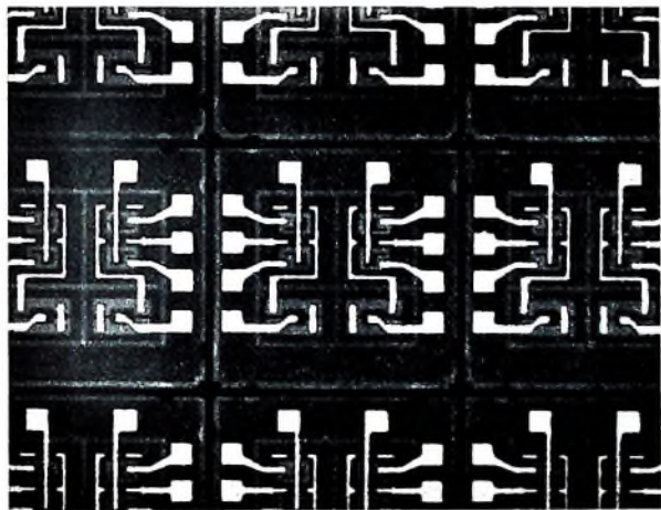
Beispiel für einen experimentellen Festkörper-Schaltkreis (Tab. I, Gruppe D): Doppelanordnung von jeweils zwei Transistoren, die Collector und Emitter gemeinsam haben, sowie von jeweils zwei Widerständen mit Mittelanzapfung; links: Ausschnitt aus der Siliziumscheibe, rechts: fertig montiertes System mit Zuführungsdrähten
