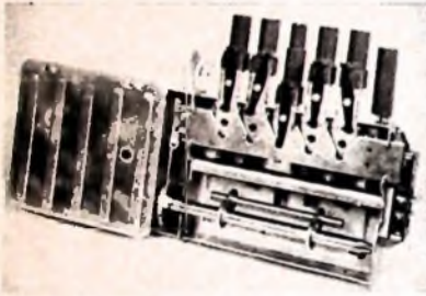
Bild 7 (unten) Der Einblock-VHF-UHF-Tuner mit angebautes Druck-tastenaggregat
