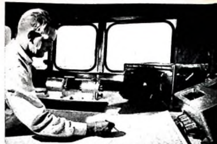
Bild 4: Der „Hi-Fix“-Empfänger im Steuerhaus des Vermessungsschiffes „Nige Wark“
