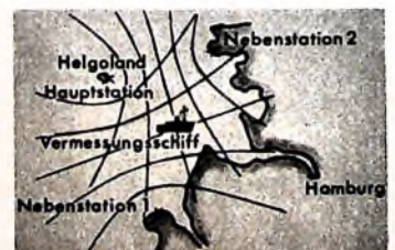
Bild 5: Die „Hi-Fix“-Kette für Vermessungsaufgaben im Wattenmeer an der Elbemündung
