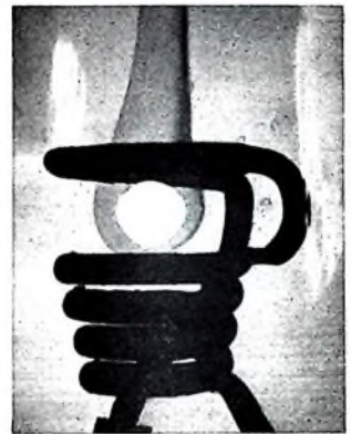
Bild 5 (links). Levitation einer frei schwebenden Wairamkugel von 7 mm Ø bei etwa 2600 °K. Bild 6 (rechts). Levitation einer frei schwebenden, von einer Kupferdampfhülle umgebenen flüssigen Kupferprobe von 7,5 mm Ø bei etwa 1500 °K
