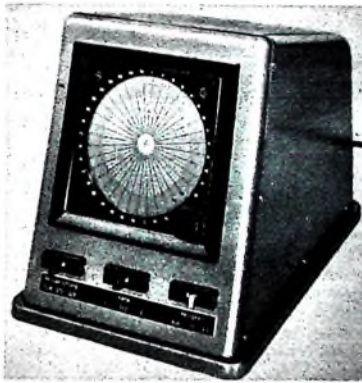
Bild 11. Lichtkoordinatenzeiger als Sichtgerät zur Auswertung der Peilung beim Dopplerpeiler
