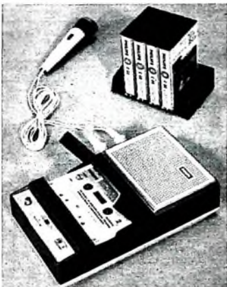
„Cassetten-Recorder 3301“ mit eingelegerter Musik-Cassette, Mikrolon und Archiv-Ständer für 6 Cassetten-Boxen
