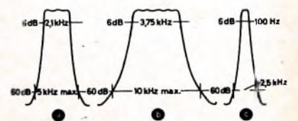
Bild 5. Die Durchlaßkurven der drei Quarzfilter für SSB (a), AM (b) und CW-Empfang (c)
