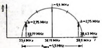
Bild 30 Kreisdiagramm zur Berechnung eines dreistufigen HF-Verstärkers mit versetzten Einzelkreisen
