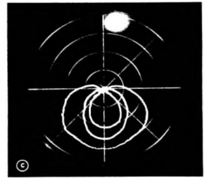
Bild 12. Richtcharakteristiken des Mikrofons „D 202“ bei verschiedenen Frequenzen: a) von außen nach innen: 125 Hz, 250 Hz, 500 Hz; b) von außen nach innen: 1 kHz, 2 kHz, 4 kHz; c) von außen nach innen: 8 kHz, 12 kHz, 16 kHz
