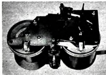
Bild 3. Teilansicht des Antriebs- teils mit den Bandtrommeln
