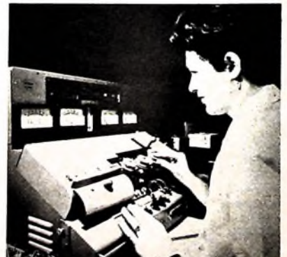
Bild 8. Prüfeinrichtung für Stereo-Tonköpfe
