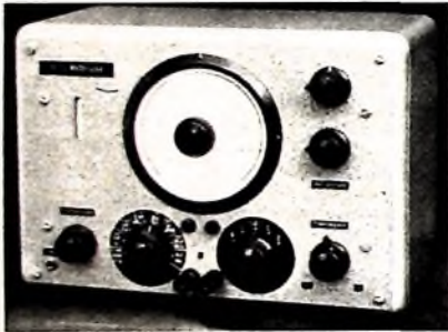
Bild 2. Ansicht der RLCZ-Meßbrücke
