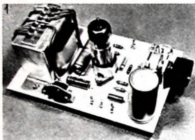
Bild 1. Gesamtansicht der Gegentakt-Endstufe
