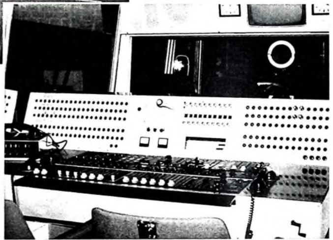
Oben: Der Stereo-Übertragungswagen des Süddeutschen Rundfunks. Unten: Der Regie- tisch an der vorderen Schmalseite des Übertragungswagens (mit Blick durch den Fahrerstand)
