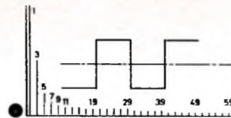
Bild 7. Rechtecksignalübertragung bei einem zweigliedrigen Abschwächer
