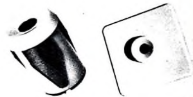
Bild 4 (links). Abschirmfassung „GKF 11“ des elektronischen Druckknopfes. Bild 5 (rechts). Beispiel einer Frontplatte zur Montage des elektronischen Druckknopfes mit Abschirmfassung
