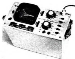
Mit Hilfe des zusätzlich einschaltbaren Eingangsteilers 1:10 werden der Eingangswiderstand auf 1 MOhm und die Ablenkkoeffizient auf 1 V/cm verändert. Bei vorgeschaltetem Trennkondensator – zum Verstärker der Wechselspannung ohne Gleichspannungsanteil – beträgt die untere Grenzfrequenz 4 Hz beziehungsweise 0,4 Hz. Die eingebaute Batterie reicht für einen ununterbrochenen Betrieb bis zu 8 h und kann über ein Netzgerät aus dem Lichtnetz gepuffert oder nachgeladen werden.
