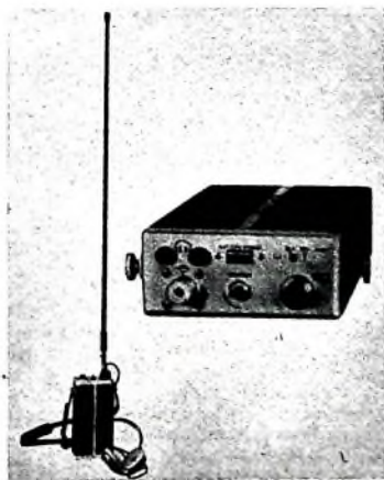
Sende- und Empfangsanlage „SM 72 TE“ (Beyer)
