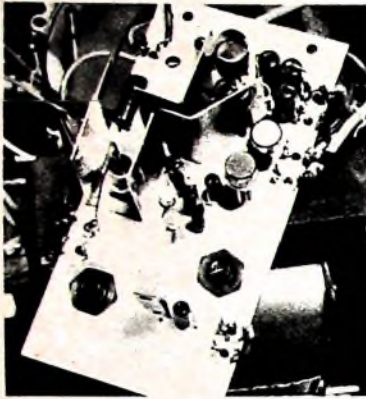
Bild 7. Montage der Bauteile der Regelschaltung auf der Isolierstoffplatte
