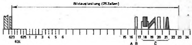
Bild 133. Lage der Prüfzeile (B) im 1. Halbbild und schematische Darstellung möglicher Prüf- und Meßsignale (C)
