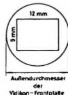
Bild 10. Abmessungen der Maske zur Erzeugung der Schwarzscherlen
