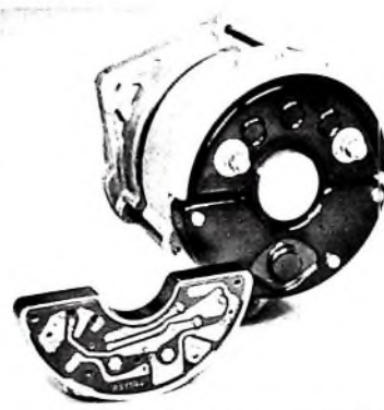
Bild 6. Pkw-Generator mit eingebautem Regler
