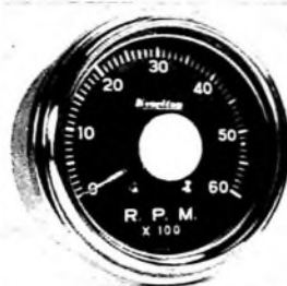
Bild 6. Speziell für Drehzahlmesser bestimmtes Meßwerk
