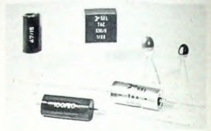
Bild 1. Verschiedene Bauformen von Tantal-Elektrolytkondensatoren
