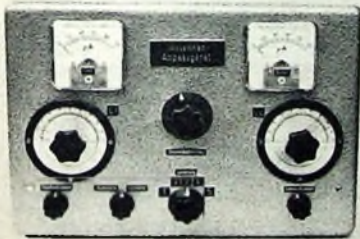
Bild 1. Ansicht des Antennenanpaßgerätes
