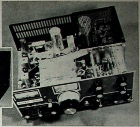
Bild 2. Chassisansicht von oben mit Sender-Endstufe (rechts hinten im Abschirmkäfig)
