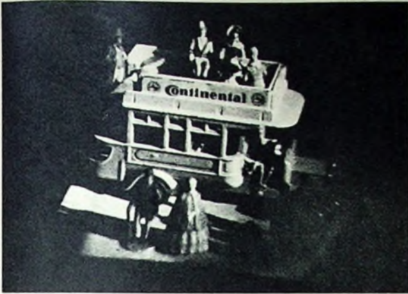
Bild 6. Zwei aus demselben Hologramm gewonnene Rekonstruktionsbilder mit veränderter Perspektive durch seitliches Verschieben der Kamera (Aufnahme des virtuellen Bildes)
