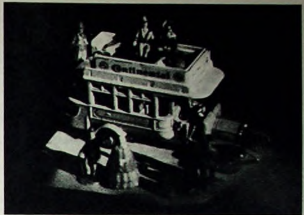
Bild 6. Zwei aus demselben Hologramm gewonnene Rekonstruktionsbilder mit veränderter Perspektive durch seitliches Verschieben der Kamera (Aufnahme des virtuellen Bildes)
