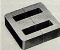
Bild 1. Doppel-E-Kern aus „Keraperm 409“ für Transduktoren zur Kissenzerrung in Farbfernsehempfängern in etwa natürlicher Größe (Kantenlänge 25 mm)
