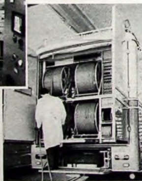
Blick auf die Bildregie (links) im Übertragungswagen. Für den Übertragungswagen mußten etwa 2,5 Mill. DM aufgewendet werden; jede der vier im Wagen mitgeführten Plumbicon-Kameras kostet bereits etwa 230.000 DM. Im rückwärtigen Teil des Wagens (unten) sind die Anschlußkabel für die Kameras untergebracht.
