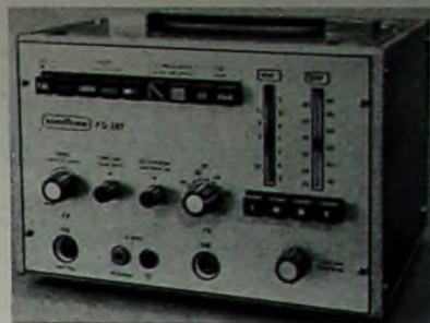
Bild 1. Die übersichtlich gegliederte Frontplatte des Farbbalkengenerators „FG 387“
