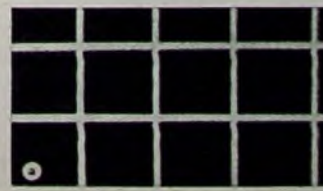
Bild 4. Bildausschnitt eines Gitterrasters: a) mit Tangenskondensator, b) ohne Tangenskondensator
