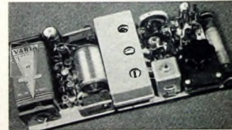
Bild 4. Gesamtansicht des Minisupers mit dem 1,5-W-Verstärker
