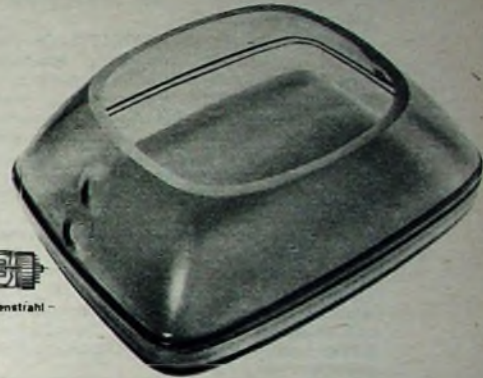
Aufbau der neuen Farbbildröhre von CFT; im obigen Foto ist im Innern des Glaskolbens das die bei Schirmmaskenröhren übliche Lochmaske ersetzende Drahtgitter zu erkennen
