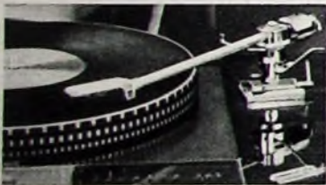
Tonarm von Audio & Design mit Quecksilberkontakten
