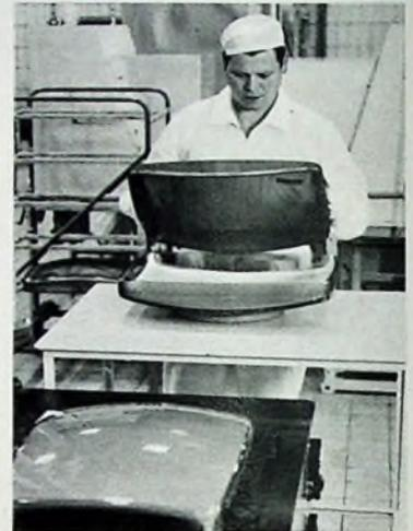
Bild 3. Einsetzen der Lochmaske vor der Belichtung
