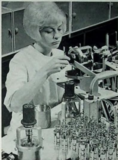
Bild 1. Montage des Dreiloch-Elektronenstrahlensystems
