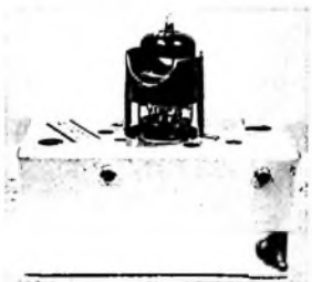
Bild 1. UKW-Tuner mit der Röhre ECC 85 (1953 bis 1967)
