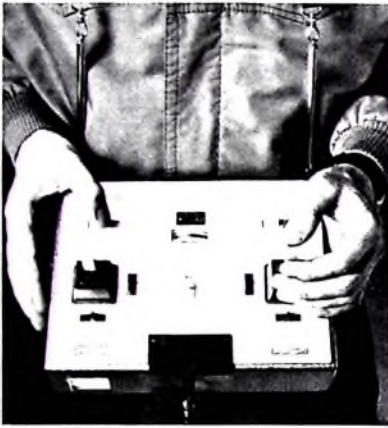
Bild 5 Durch die Aufhängung des Senders an den Tragbugeln ist beste Bedienbarkeit aller Steuerknüppel und Steuerhebel gewährleistet. Die Funktionen auf den Steuerknüppeln sind trimmbar; die Trimmhebel befinden sich neben den Knüppeln
