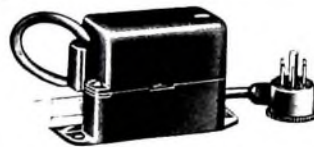
Bild 7 „Digiprop“-Rudermaschine „196/4“; die Ruderbetätigung erfolgt über den Schieber links
