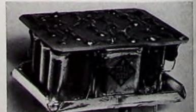
Bild 3. Quarzfilter mit einer Mittelfrequenz von 10,7 MHz
