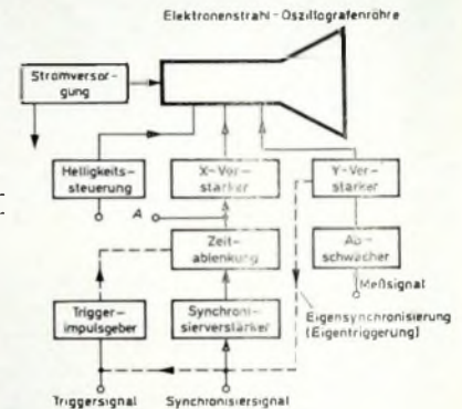
Bild 9. Die wichtigsten Baugruppen eines Elektronenstrahl-Oszillografen
