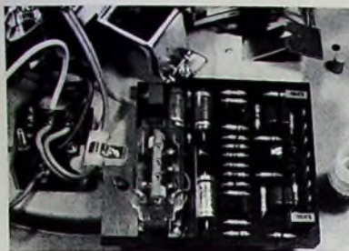
Bild 17. Entzerrervorverstärker auf der Unterseite der Platine
