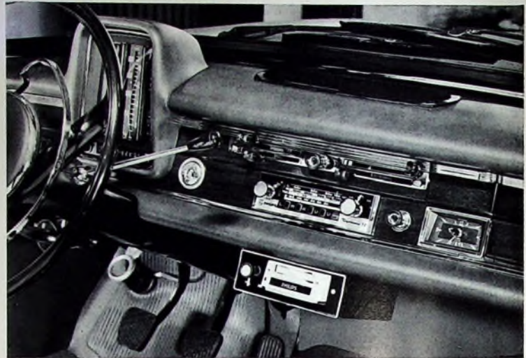
Bild 1 (oben). Der Auto-Cassettenspieler ist unterhalb des Armaturenbrettes eingebaut
