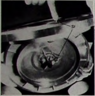
Bild 4. Spiegelaufnahme des Plattentellers. Der Steuerstift S ragt auf der Unterseite heraus und steuert den Aufsetzpunkt des Tonarms
