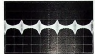
Bild 5. Modulationshüllkurve an der Mischstufenbasis bei ungenügender sperrender Vorstufe; m = 80\% am Meßsender
