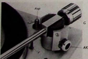
Bild 6. Tonarmlager mit Gegengewicht G, Einstellknopf AK für Auflagekraft und Antiskatingkraft sowie Ausgleichseinstellung Asgl für unterschiedliche Abtastverhältnisse; F ist der Fühlerstift zur Steuerung des Aufsetzpunktes bei 25 bzw. 30 cm Plattendurchmesser
