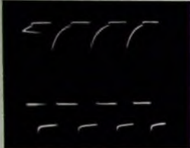
Bild 65 Kurvenformen bei einem Pentadenmultivibrator. Oberes Bild: Spannungsform am Gitter; unteres Bild: Spannungsverlauf am Schirmgitter. Infolge Umladung schädlicher Kapazitäten treten hier Zäpfel im unteren Teil der Kurve auf
