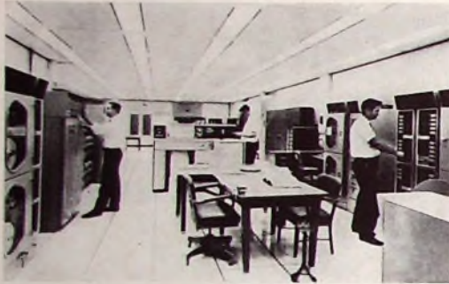
Bild 4. Verschiedene Bodenstationen des Manned Space Flight Network verfügen im Rahmen des NASCOM über diese Univac-Elektronenrechner „1230“, die der Datenverarbeitung und der automatischen Datenübermittlung dienen (Aufnahme: Univac)
