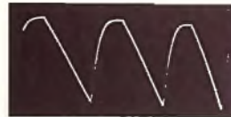
Bild 101. Ausgangsspannung eines Sanatrons bei relativ schwacher Zeitdehnung; die Wartezeit ist kurz gegenüber der Hinlaufzeit
