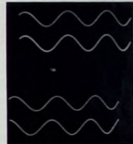
Bild 109. Einfluß der Hinlauf-linearität einer Kippschwingung auf die entstehende Kurve. Man sieht, daß die Kippschwingung nicht absolut linear war, denn der Abstand zwischen den Maxima der Sinusschwingung wird immer größer ▶
