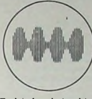
Bild 10. Umhüllende bei Übersteuerung des Exciters oder der Linear-Endstufe
