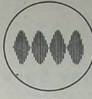
Bild 9. Umhüllende bei Zweitonansteuerung und einwandfrei eingestellter Endstufe
