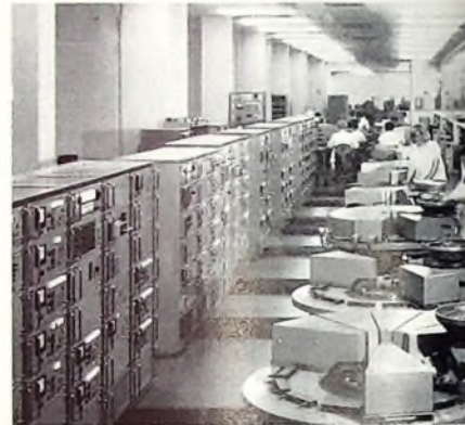
Automatische Prüfanlagen für Halbleiter-Bauelemente im AEG-Telefunken-Halbleiter-Prüfwerk
