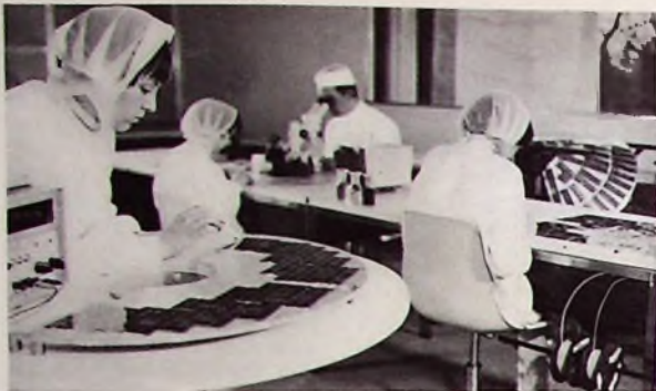
Bild 2. Fertigung des Sonnenzellengenerators im Super-Clean-Room des AEG-Telefunken-Werks Wedel
