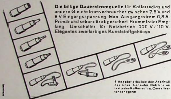
Die billige Dauerstromquelle für Kofferradios und andere Gleichstromverbraucher zwischen 7,5V und 9V Eingangsspannung. Max. Ausgangsstrom 0,3 A. Primär- und sekundärabgesichert. Brummfreier Empfang. Umschalter für Netzbetrieb 220 V/110 V. Elegantes zweifarbiges Kunststoffgehäuse.
