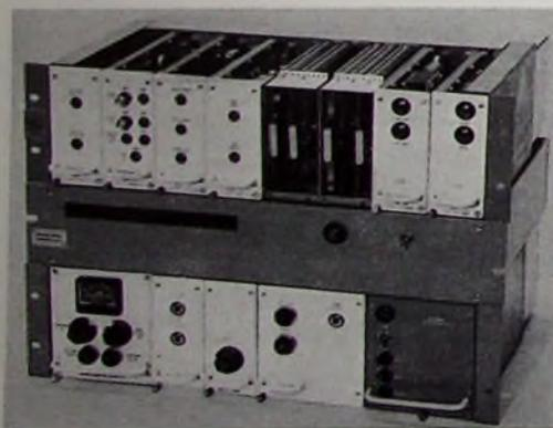
Bild 3. Gestell der Versuchseinrichtung auf der Sendeseite mit Analog-Digital-Wandler und PCM-Addierstelle
