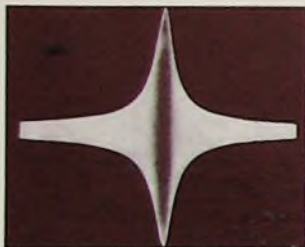
Bild 28. Eine Wobbelkurve (Resonanzkreis) bei unmittelbarer Darstellung der Hoch- oder Zwischenfrequenz
