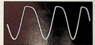
Bild 48. Aus dem Leuchtschirmbild kann man sehr deutlich beispielsweise die Begrenzung einer Sinuslinie (obere Halbwellen) erkennen.
