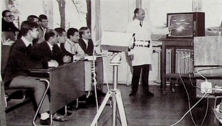
Untersuchung eines Multivibrators mit Hilfe eines Zweistrahloszillografen. Damit auch in einem großen Unterrichtsraum in der Technikerschule alle Studierenden das Schirmbild gut beobachten können, wird es über eine Fernsehkamera dem Fernsehempfänger zugeführt
