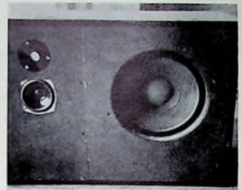
Bild 5 Außenansicht der Lautsprecherbox (rechts: Tieftonlautsprecher „W 15/RS“; links Mitte: Mitteltontsystem „B 110“; darüber Hochtonlautsprecher „T 27“)
