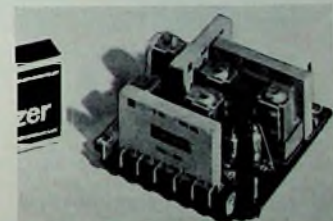
Bild 10. Stereo-Automatik-Decoder „10“ von Grundig mit drei Dickfilm-Modulen
