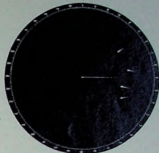
Bild 1. Kollisionsgefahr-darstellung eines Relativbewegungsradars
