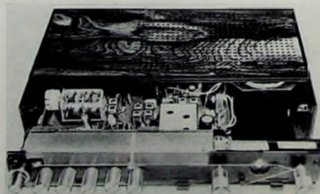
Bild 15. Servicefreundliches Universalchassis von Imperial General Electric im Kofferempfänger „RP 235“
