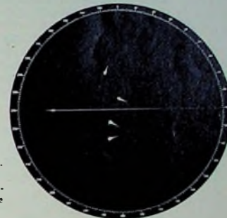
Bild 2. Rund-sichtanzeige eines Manöverradars (wahre Bewegung)
