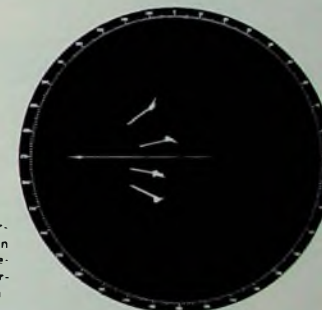
Bild 3. Manöverradar mit den sich relativ bewegenden Markierungslinien
