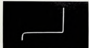
Bild 90 Darstellung der Kennlinie einer Z-Diode (Zenerbereich und Durchlaßbereich sind sichtbar)
