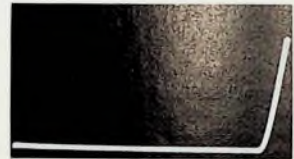
Bild 89 Darstellung der Kennlinie einer Germaniumdiode; der Anstieg ist relativ flach
