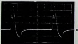
Bild 7. Eingangsstrom des Verdreifachers bei 1 mA Strahlstrom, jedoch 14 \mu s Rücklaufzeit (vertikal: 20 mA/Tlg., horizontal: 10 \mu s/Tlg.)
