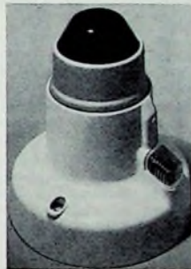
Bild 3. Flammenmelder „SES 5 A“ von Cerberus; die Sammellinse läßt nur UV-Strahlung durch
