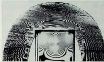
Bild 1b. Folelastisches Bild mit den Druckkräften der gewickelten Verbindung
