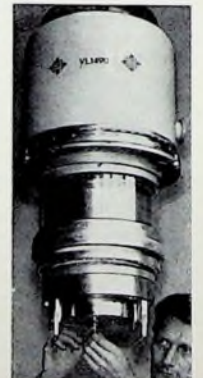
Bild 2. Montage des Systems einer Hochleistungstetrode YL 1490, die zu den stärksten KW-Senderöhren der Welt gehört
