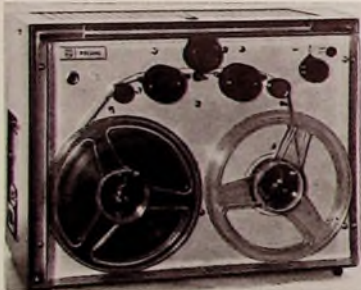
Bild 3 (unten) Abspielautomat „SM 9900“ für die Wiedergabe funktioneller Musik mit vertikal angeordneten Bandschulen
