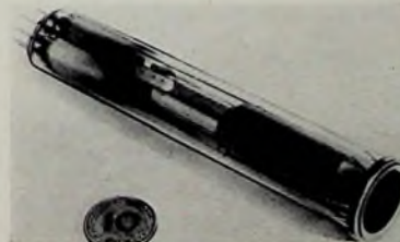
Bild 1. Ansicht der Telecon-Kameraröhre
