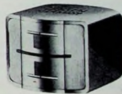
Der UKh 202 ist ein Universal-Kombinationsmagnetkopf für ein 1/4"-Magnetband in 1/2"-Spur-Technik. Seine
