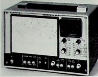
Bild 3. Millivoltmeter „MV 5-O“ mit eingebautem Kleinoszillografen (Grundig)
