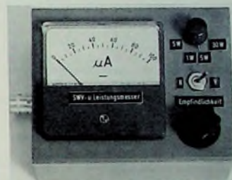
Bild 3. Reflektometer und Leistungsmesser (Außenansicht); verwendetes Gehäuse: „KG-333“ von H. Knurr, München
